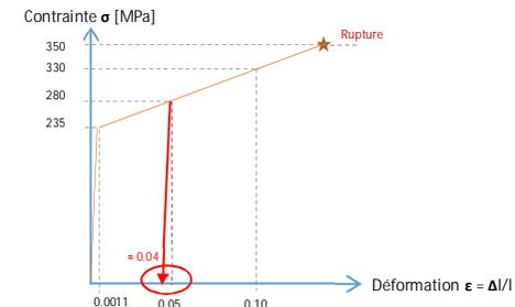
$$\text{Déformation rémanente} : 0.04 * 50\,000 \text{ mm} = 2\,000 \text{ mm} (= 2 \text{ m!})$$
