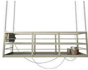
L'échafaudage, long de 4 mètres est constitué d'une poutre en bois suspendue à deux câbles de diamètre 3 mm.
